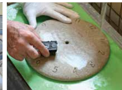
骨材がムラなく表出するまで表面を洗い流す。
