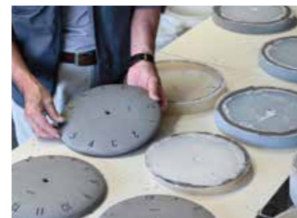
型枠からの取り外し。表面は平滑な状態。
